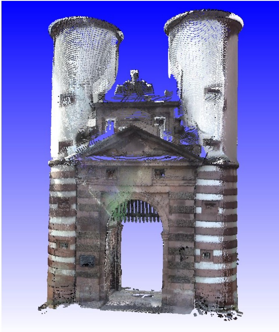
Abbildung 7: 3D-Laserscan der Südtürme der „Alten Brücke“ in Heidelberg. Man sieht hier deutlich, dass die Punktdichte zu den Spitzen hin abnimmt, und dort viele Lücken auftreten, da der Scanner während den Aufnahmen nur auf dem Boden positioniert werden konnte.
