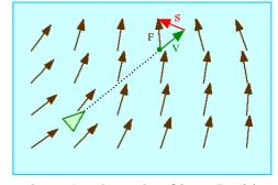
als Vektoren mit definierter Richtung und Länge vorgegeben. An der zukünftigen Position des bewegten Objekts wird der dort gültige Vektor des Flussfeldes ermittelt. Dies geschieht in der Regel durch Interpolation zwischen benachbarten Werten, falls die Werte (Stärke und
