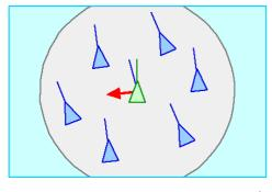
"Ausrichten" ist eine weitere Fertigkeit, die schon einen Ausblick auf die Bewegung mehrerer Individuen bietet. Die Bewegung des betrachteten Individuums soll an die seiner Nachbarn angepasst werden. Dazu wird von allen Individuen innerhalb eines bestimmten Radius der gewichtete (vgl. "Separieren") Mittelwert von deren Bewegungs-Vektoren errechnet. Dieser ist zugleich die gewünschte Geschwindigkeit, die Differenz zur eigenen Geschwindigkeit ist das Steuersignal.
