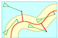
eine Vorhersage über dessen zukünftige Position getroffen, vergleichbar mit der aus "Hindernis-Vermeiden". Ist diese Position ausserhalb eines gewissen Korridors um dem Pfad, wird mit den Steuerwerten der Fähigkeit "Aufsuchen" korrigiert. Als Ziel dafür wird der Punkt auf dem Pfad verwendet, welcher der vorher berechneten zukünftigen Position am nächsten liegt. Weitere Parallele zum "Hindernis-Vermeiden": Befindet sich die zukünftige Position –
