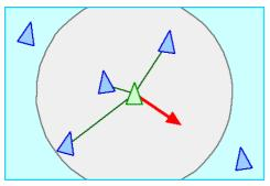
der Verlust der Manövrierfähigkeit vermieden werden. Das Steuerungssignal wird berechnet, indem zunächst die Individuen bestimmt werden, die sich innerhalb eines kritischen Bereiches aufhalten. Diese erzeugen jeweils eine abstoßende Kraft. In Versuchen [4] hat es sich als praktikabel erwiesen, deren Größe umgekehrt proportional zum Abstand der beiden Individuen zu wählen. Die resultierende Steuerung ergibt sich aus der Vektoraddition aller abstoßenden Kräfte.
