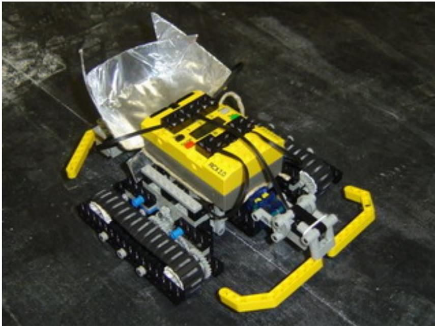
Abbildung 9.2: Der Roboter mit optimierter Antenne
