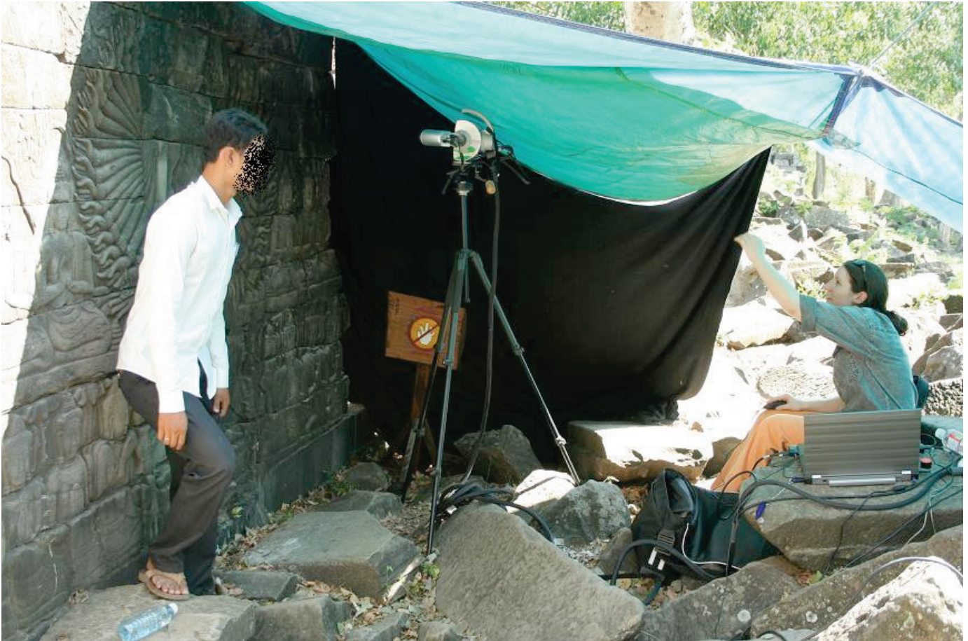
Scannen des Reliefs der vielarmigen Lokesvara des Bas-reliefs auf der westlichen Seite des Tempelkomplexes in Banteay Chhmar
